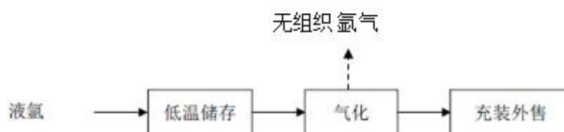
图 2-4 氩气生产工艺流程图及产污过程图
